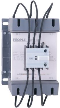
RDC19系列B切换电容器接触器,适用于交流50Hz(或60Hz),额定工作电压至400V的电力线路中,供低压无功功率补偿设备投入或切除低压并联电容器之用,接触器附有抑制涌流装置,不用加装限流电抗器就能有效抑制合闸涌流对电容器的冲击和降低开断瞬时的过电压。
