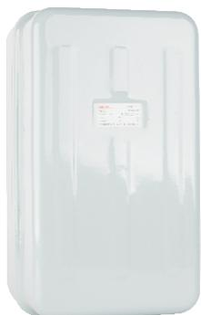
RDQ12、20系列电磁起动器（以下简称起动器）主要适用于交流50HZ（或60HZ），额定电压至690V，电流至150A的电力电路中，主要用于三相鼠笼式感应电动机的起动和停止，对电动机的过载、断相起保护作用。
