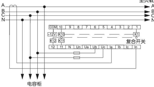
图3 JKW5C接线图(取样电压380V)
