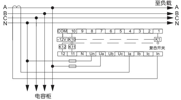
图4 JKW5C接线图(取样电压220V)
