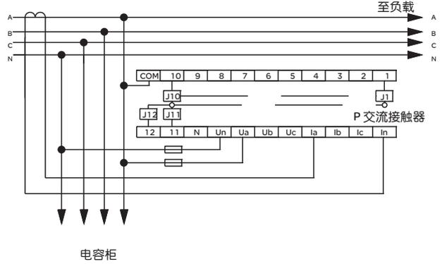
图2 JKW5C接线图(取样电压220V)
